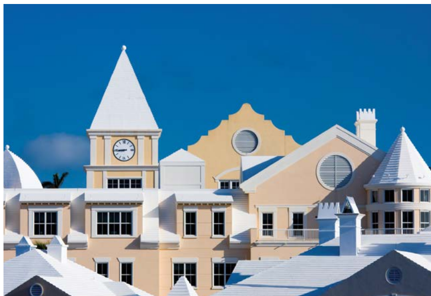
Bílé střechy domů v Hamiltonu (Bahamské ostrovy) významně brání přehřívání střech a interiéru domů za slunných dní.
