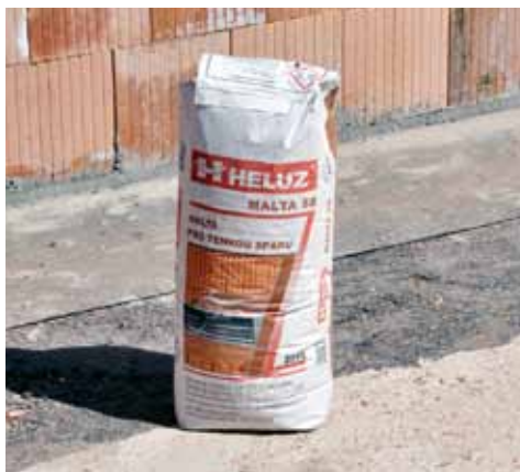
HELUZ malta SB (lepidlo). Nanáší se na žebra broušených tvarovek v tl. 1 mm
